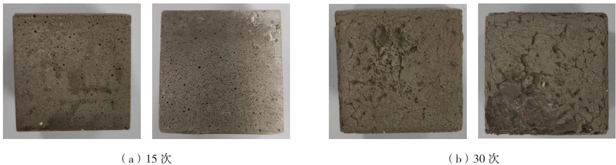
图 5 GS-2 组水泥砂浆试件在不同冻融循环次数下的表观形貌
